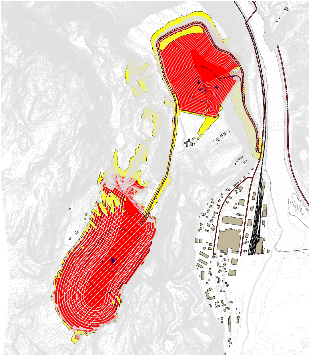
Figur 2: Støysonekart i slutten av driften i 4 meters høyde. Gul sone L_{den} 55 dB - 65 dB, Rød sone L_{den} \geq 65 dB.
