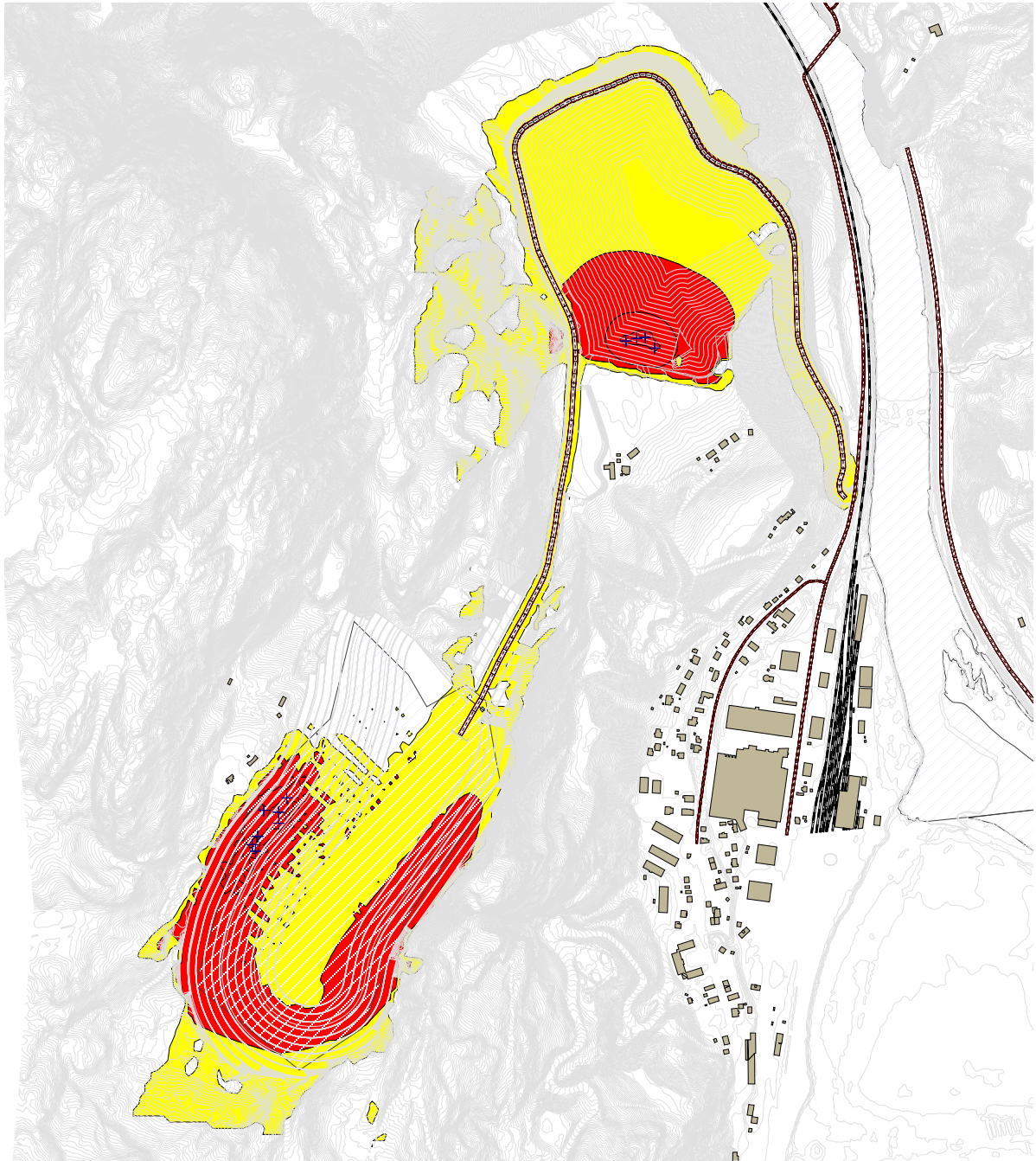
Figur 1: Støysonekart i starten av driften i 4 meters høyde. Gul sone L_{den} 55 dB- 65 dB, Rød sone L_{den} \geq 65 dB.
