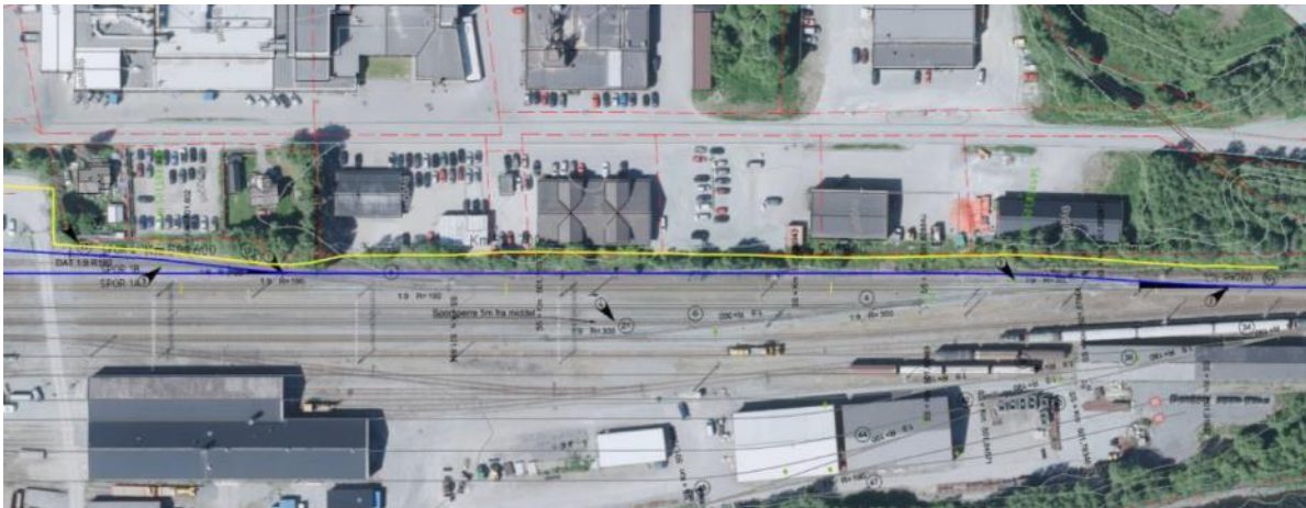
Figur 21 Gul linje markerer mulig skråningsutslag mot eiendommer langs Bygget.
