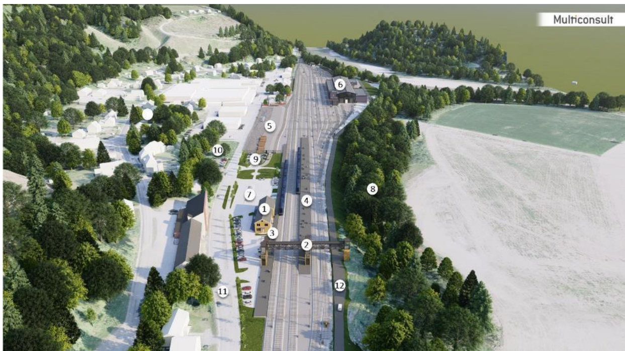
Figur 18 Oversiktsillustrasjon av fremtidig situasjon, sett sør mot nord viser stasjonsbygning (1), overgangsbru (2), sideplattform (3), mellomplattform (4), godsterminal (beredskaps) (5), verkstedbygg (6), bussholdeplass (7), grøntareal (8), parkering (9,10), fv. 6653 Bygget (11), adkomstveg til verksted og hensetting (12) Ny gang-/sykkelveg langs Bygget er manglet på illustrasjonen. (Visualisering Multiconsult).
