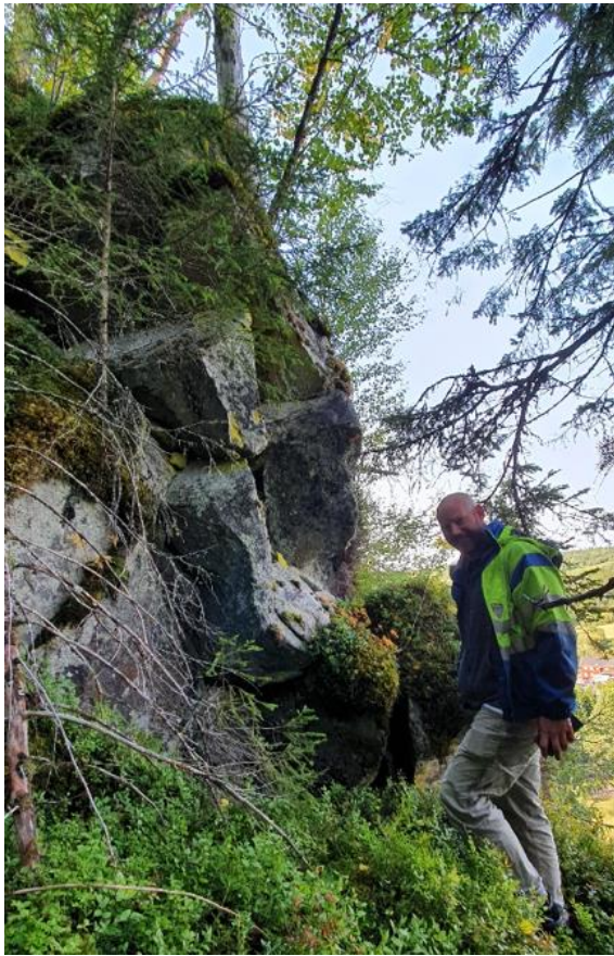
Figur 21. Feltbilder fra befaringen som ble utført september 2020. Det ble observert oppsprukket berg og avløst blokker med omtrent volum på 1- 2m 3 (Kilde: Rambøll).
