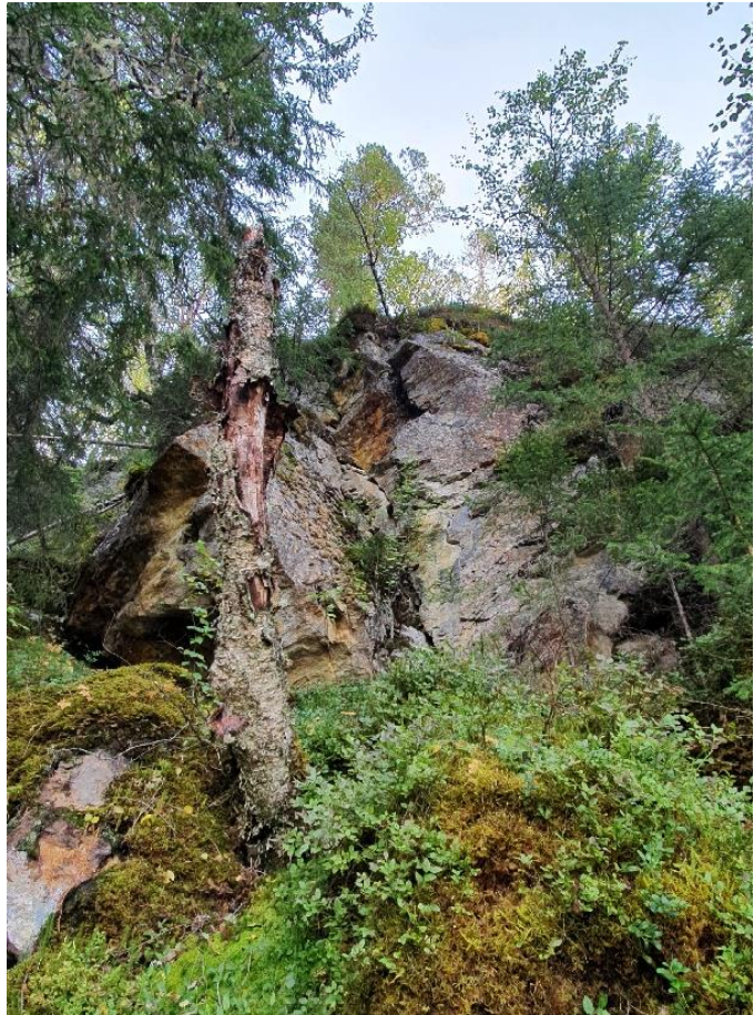
Figur 21. Feltbilder fra befaringen som ble utført september 2020. Det ble observert oppsprukket berg og avløst blokker med omtrent volum på 1- 2m 3 (Kilde: Rambøll).
