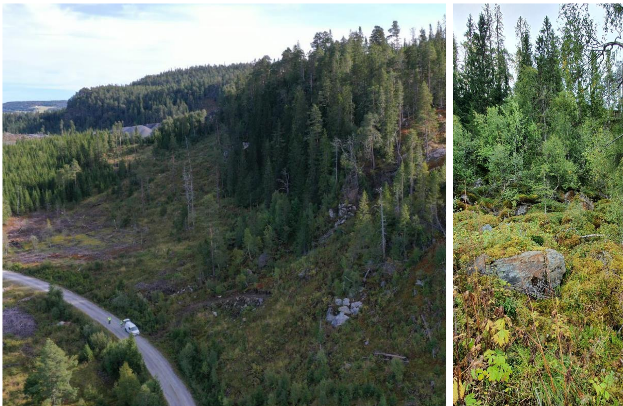
Figur 24. Drone bilde av skråningen i sektor 2 (kilde: Rambøll, 2020), og terrengbilder som viser steinsprangavsetninger.
