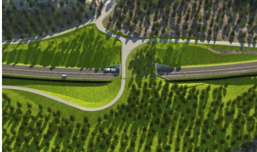
Figur 6. Prinsippskisse for utforming av viltovergang ved Kubastu (Modell: Rambøll).
