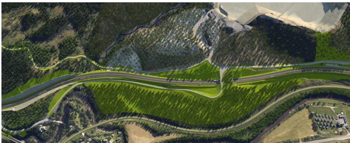
Figur 2 Flytting av Kubastu viltovergang - med kryssing av lokalveg
