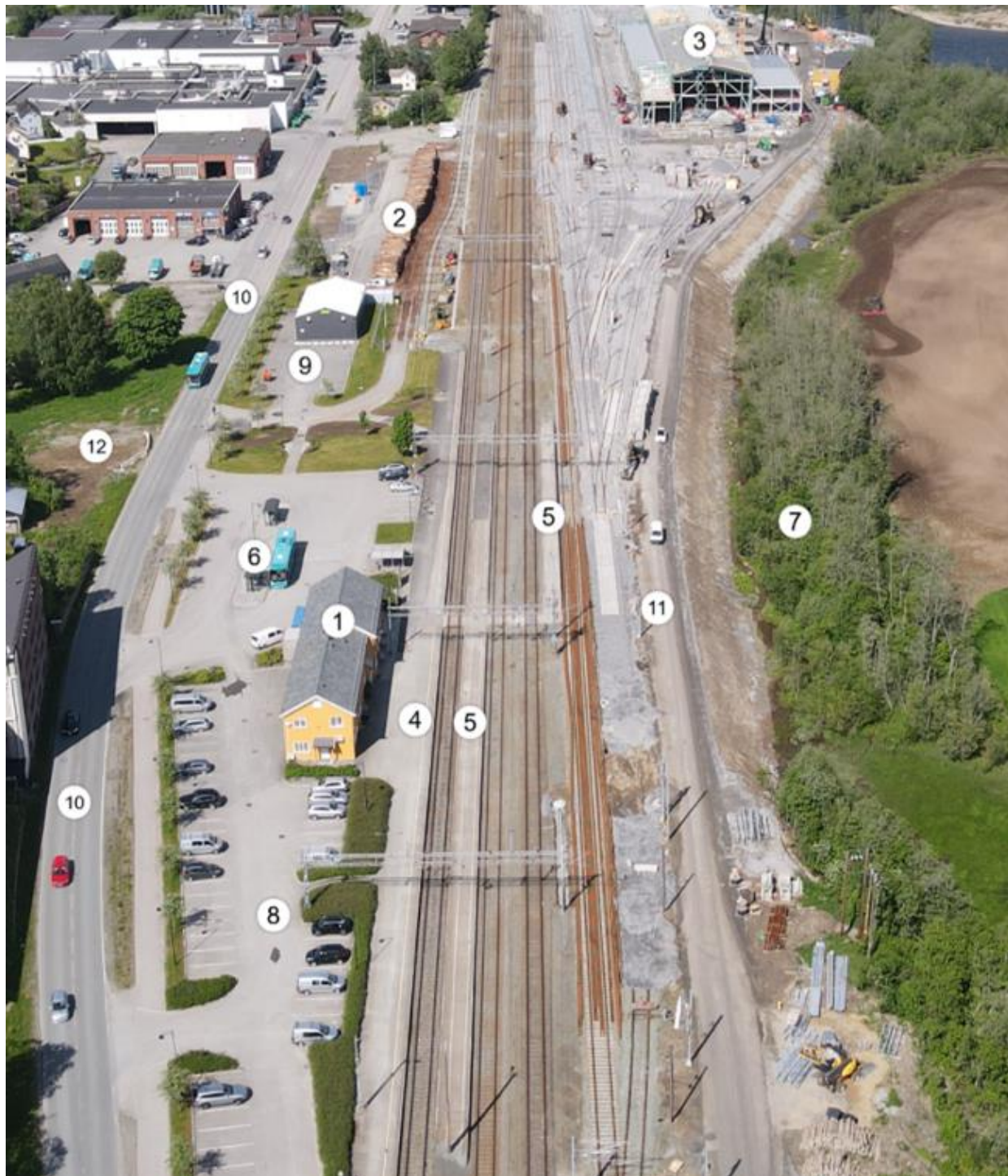
Figur 4: 1 stasjonsbygning, 2 gods-/beredskapsterminal, 3 verkstedbygg, 4 sideplattform, 5 mellomplattform, 6 på/avstigning buss, 7 grøntområde, flomutsatt, 8 parkering, 9 parkering, 10 adkomstveg til stasjon, 11 adkomstveg til verkstedbygning, 12 Bane NOR Eiendoms grunn.
