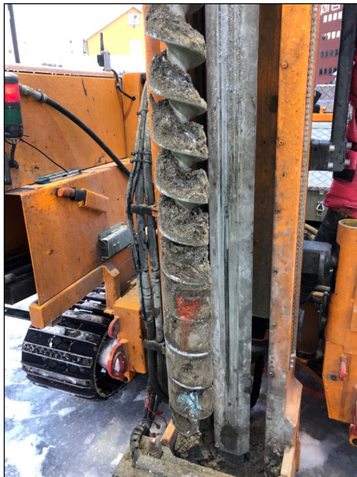
Figur 15 SP10 0-1 meter. Blandede fyllmasser av leire, jord, sand og grus. Innslag av tegl. Foto: Multiconsult, 22.02.2022.
