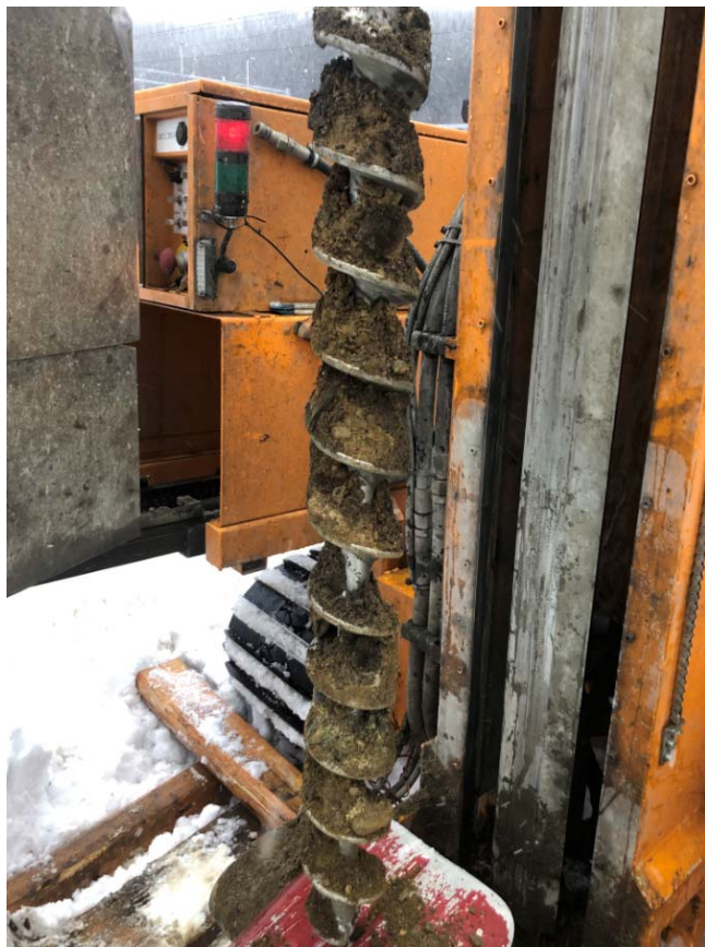
Figur 18 SP22 0-1. Lyse og mørke fyllmasser av sand og grus med organisk innhold. Foto: Multiconsult, 25.02.2022.
