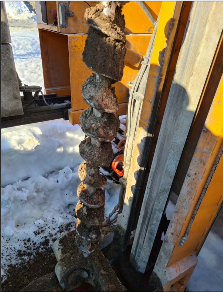
Figur 22 SP35 1-2. Fyllmasse av sand med noe grus. Innslag av tegl og noe antatt knust betong. Foto: Multiconsult, 01.03.2022.
