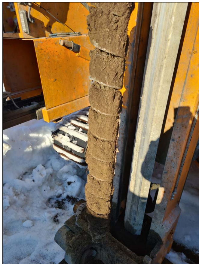
Figur 21 SP35 0-1. Mattjord med noe innslag av tegl. Foto: Multiconsult, 01.03.2022.
