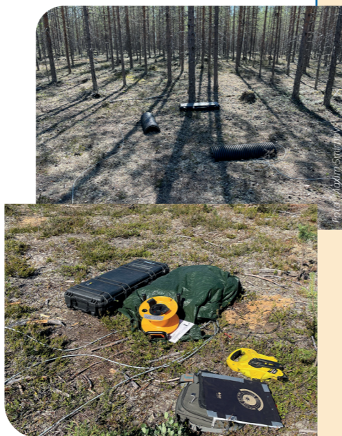
HER ER INSTRUMENTENE SOM BRUKES I FELT. Magnetometriske sonder blir dekket til for å beskytte dem mot regn og vind. Elektroder er koblet til et måleinstrument med en cirka 50-100 meter lang kabel.
