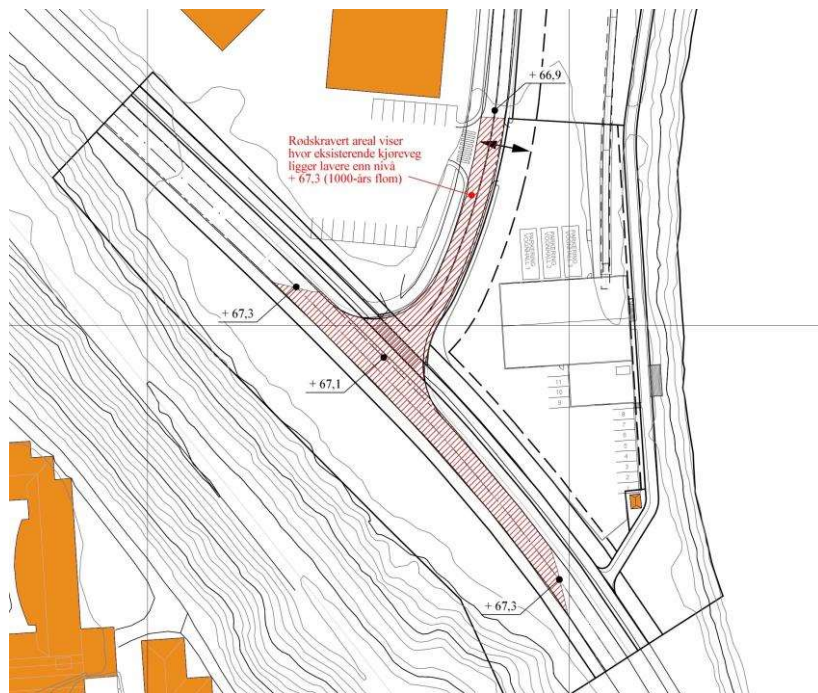
Bilde 6: Høyde adkomstveg til brannstasjon. Rødskravert område ligger lavere enn nivå for 1000-års flomsituasjon.
