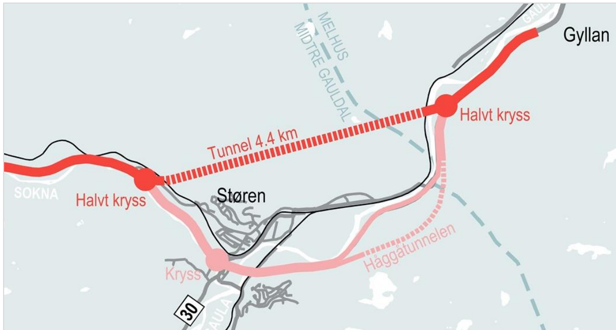
Figur 1-6: Tunnelalternativ for E6 ved Støren, hvor E6 går i tunnel gjennom Mannfjellet.
