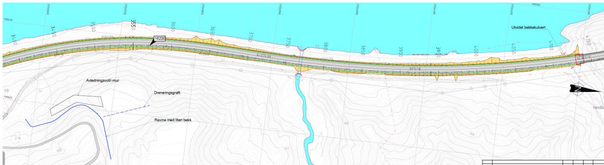
Figur 4-10 Utbedring av E6 sør for Håggåtunnelen med tiltak for å styre overvann og redusere rasfare. Kilde: Norconsult.
