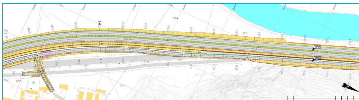
Figur 4-14 E6 og lokalveg ved eksisterende bebyggelse på Håggån. Eksisterende E6 og lokalveg fjernes og areal avsettes til dyrka mark. Kilde: Norconsult.
