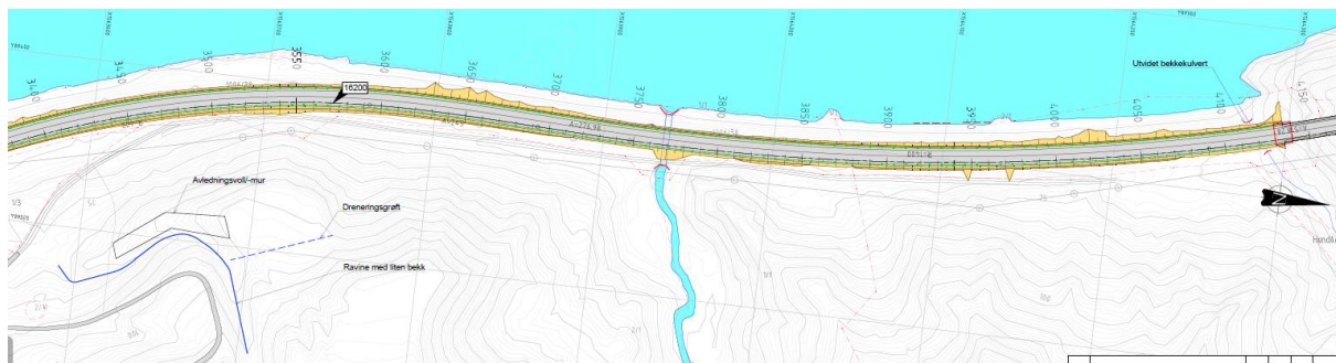
Figur 10 Utbedring av E6 sør for Håggåtunnelen med tiltak for å styre overvann og redusere rasfare
