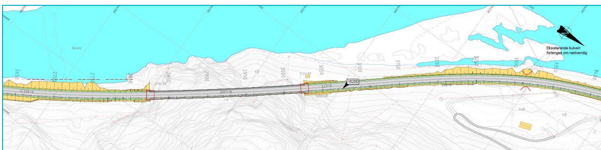
Figur 10: Utbedring av eksisterende E6 ved Brattlitunnelen. Vegfylling i Gaula og behov for erosjonssikring. Kilde: Norconsult.
