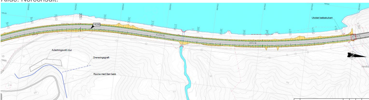
Figur 11: Utbedring av E6 sør for Håggåtunnelen med tiltak for å styre overvann og redusere rasfase. Kilde: Norconsult.
