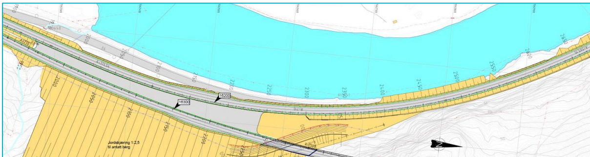
Figur 9 Utbedring av eksisterende E6 med vegfylling ut i Gaula og behov for erosjonssikring.
