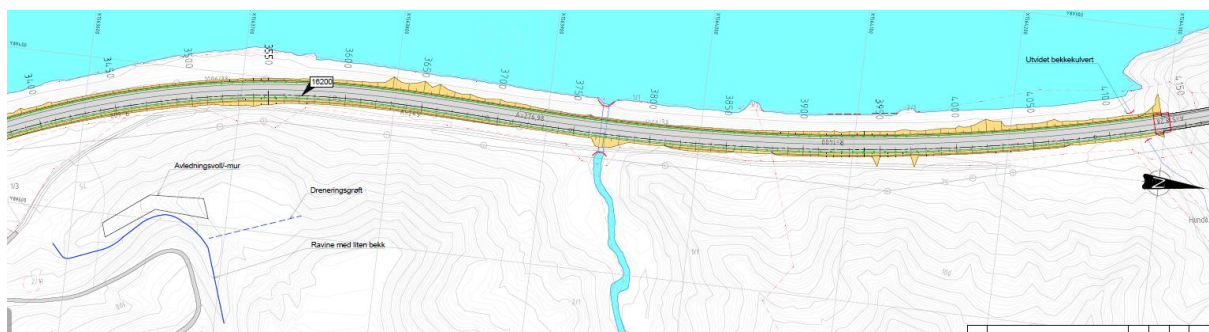
Figur 11 Utbedring av E6 sør for Håggåtunnelen med tiltak for å styre overvann og redusere rasfare.
