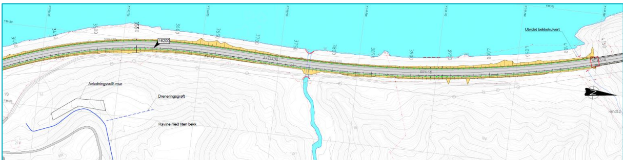
Figur 10: Utbedring av E6 sør for Håggåtunnelen med tiltak for å styre overvann og redusere rasfare.
