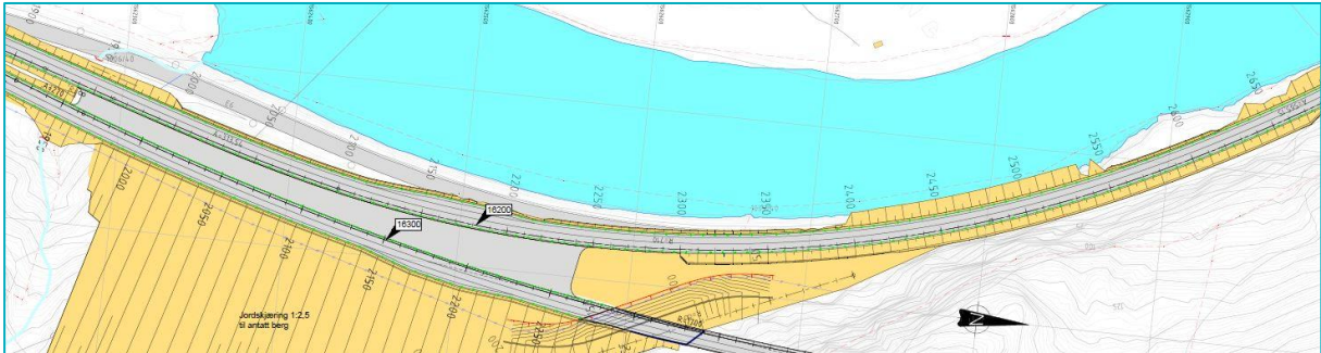
Figur 8: Utbedring av eksisterende E6 med vegfylling ut i Gaula og behov for erosjonssikring
