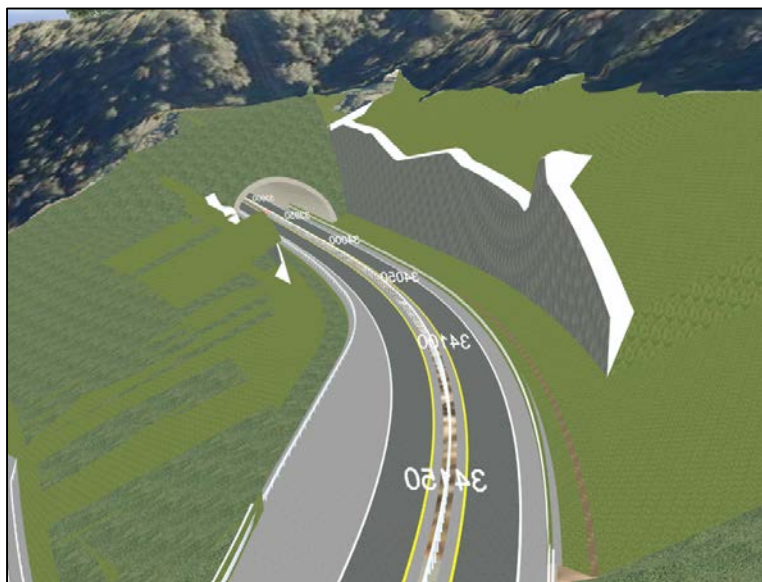
Figur 5-5: 3D-modell nordre tunnelpåhugg, fjellskjæring mot jernbane.
