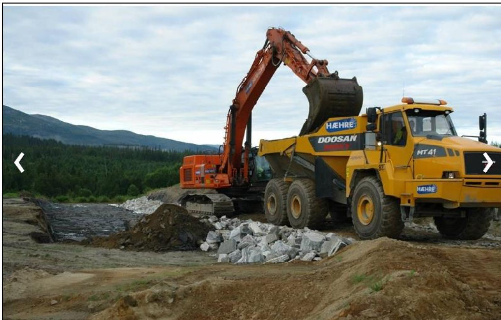
Figur 6-1: Bilde viser leddumper med ca. 40 tonns nettolast (kilde: Bygge.no, 05.11.2016).
